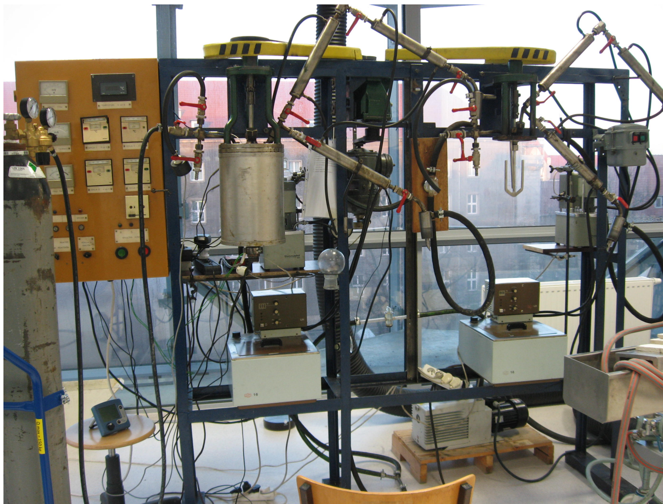
Reaktor próżniowy do syntezy poliestrów, poliwęglanów
